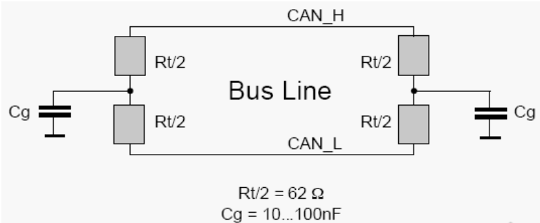
Técnica de protección frente a ruido electromagnético: Condensador de desacoplo
