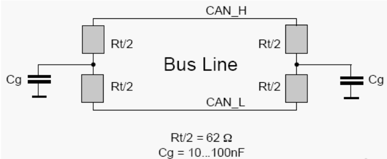
Technique de protection contre le bruit électromagnétique : condensateur de découplage
